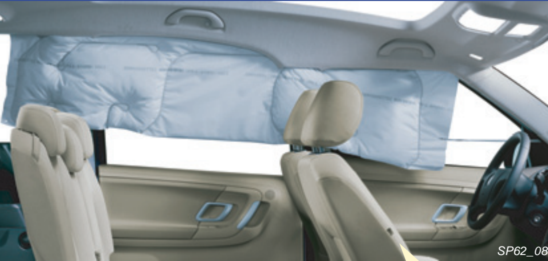
▲Kopf-Airbags für mehr Sicherheit der Fahrgäste
