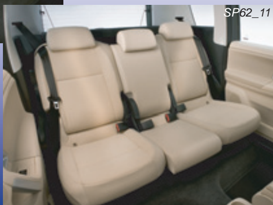
◀▼VarioFlex System zur Anordnung der Rücksitze
